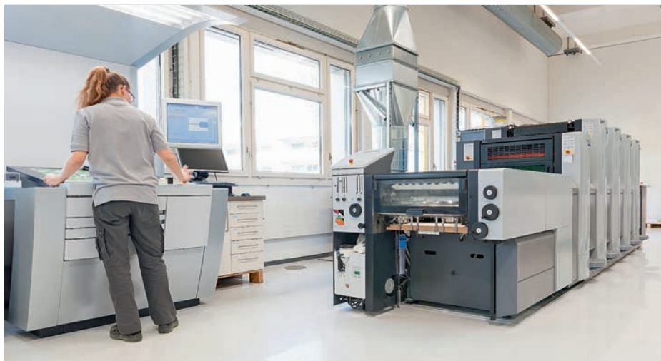
Doppelte Druckwerksanzahl im Bogenformat 37 × 32 Zentimeter: Anstelle einer Zweifarbenmaschine Speedmaster SM 52-2 produziert die Sprüngli Druck AG auf einer Vierfarbenmaschine Speedmaster SX 52-4+L mit einem Lackierwerk.
